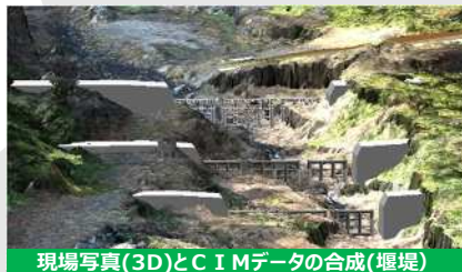
現場写真(3D)とCIMデータの合成(堰堤)
